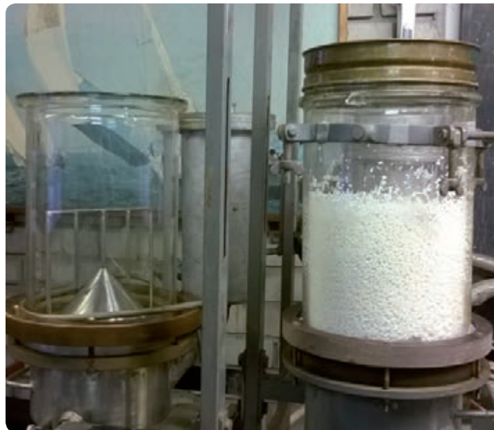
6. ábra: A pilot léptékű előállítási technológiában alkalmazott emulzió készítő recirkulációs berendezés a vezérlőpanellel (balra), és az alginát mikrokapszulák szárítására szolgáló kúpos betétes fluidizációs szárító (jobbra)
