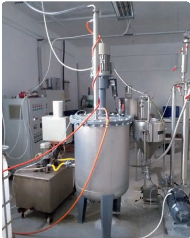
10. ábra: 200 literes polimerizációs reaktor a mikrokapszulák bevonatának kialakítására (baloldali kép), a keletkezett primer mikrokapszulák vékony polimer bevonattal (jobbaldalt fent) és a primer mikrokapszulákat tartalmazó kalcium-alginát gyöngyök előállítására és megszilárdítására szolgáló pneumatikus csepegtető a gélesítő reaktor (jobbaldalt lent)
