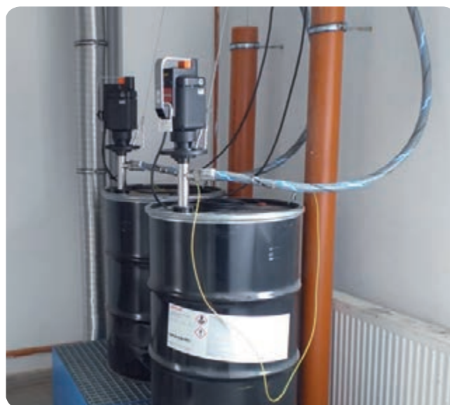
30. ábra: Paraffin tároló, keverő és betápláló tartályok (felső kép), monomer tároló, keverő és betápláló tartályok (alsó kép)
