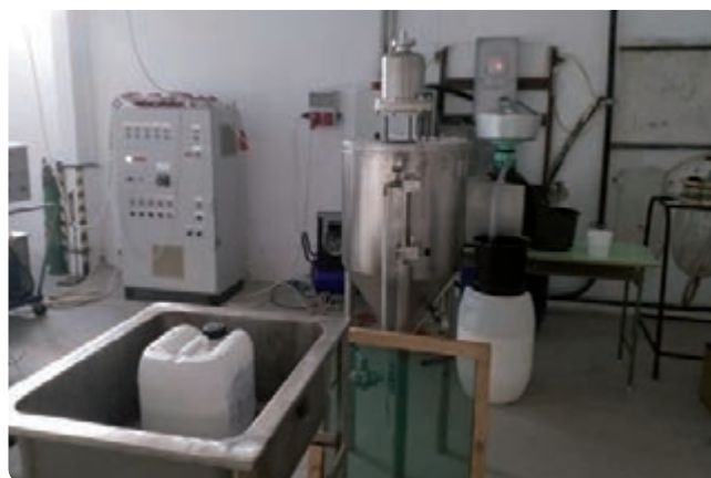
10. ábra: 200 literes polimerizációs reaktor a mikrokapszulák bevonatának kialakítására (baloldali kép), a keletkezett primer mikrokapszulák vékony polimer bevonattal (jobbaldalt fent) és a primer mikrokapszulákat tartalmazó kalcium-alginát gyöngyök előállítására és megszilárdítására szolgáló pneumatikus csepegtető a gélesítő reaktor (jobbaldalt lent)
