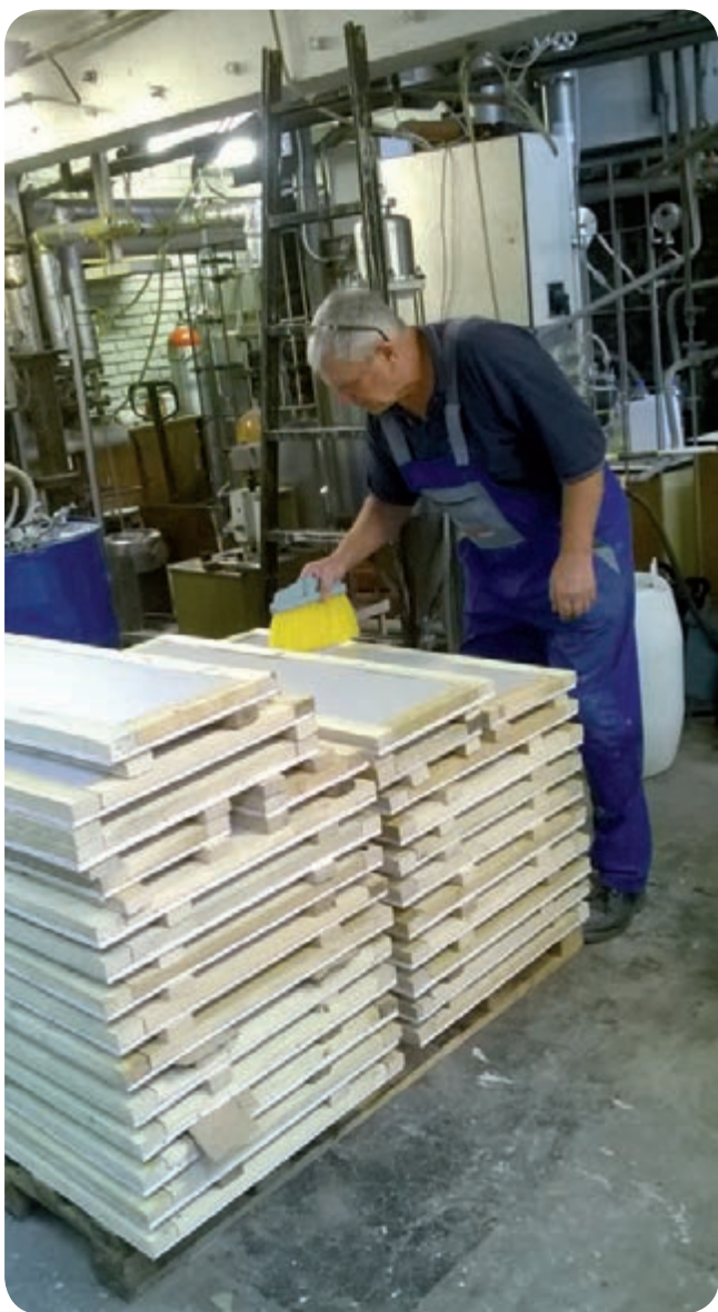
25. ábra: A hőtároló vakolatpanelek előállítás és beépítése a modellházba
