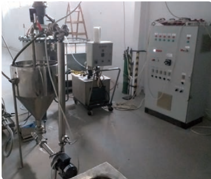
6. ábra: A pilot léptékű előállítási technológiában alkalmazott emulzió készítő recirkulációs berendezés a vezérlőpanellel (balra), és az alginát mikrokapszulák szárítására szolgáló kúpos betétes fluidizációs szárító (jobbra)
