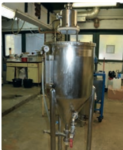
11. ábra: A pilot léptékű technológia eszközei: szerves fázis készítő tartály és hidrodinamikus emulzifikálás, polimerizációs reaktor (baloldali kép), alginát mikrogömböket előállító csepegtető és gélképző reaktor (középen), Niro Mobil Minor® porlasztva szárító (jobbra).
