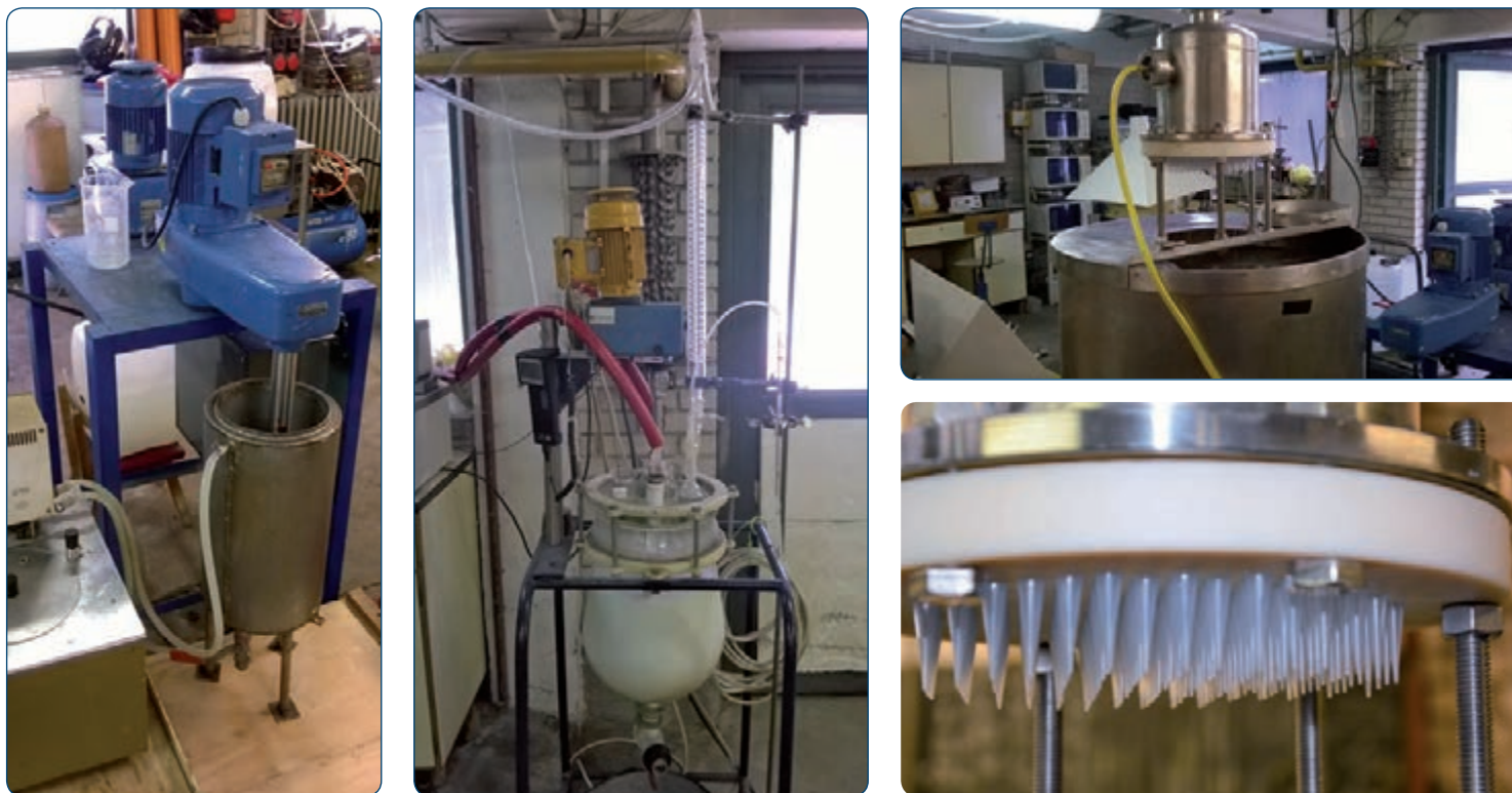
9. ábra: A pilot léptékű technológia létrehozása során összeállított berendezések balról jobbra: Ultraturrax diszpergáló, üveg polimerizációs körtereaktor, csepegtető és gélesítő reaktor, csepegtető fűvókák
