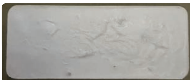
14. ábra: Sűrű zagy formátumú PCM mikrokapszulákat tartalmazó gipszes vakolat próbadarabok
