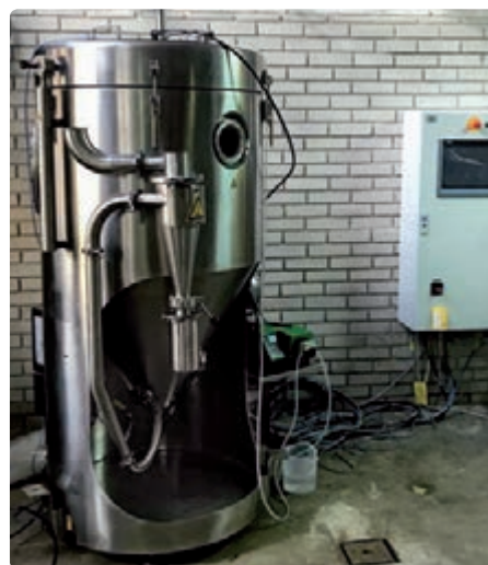
11. ábra: A pilot léptékű technológia eszközei: szerves fázis készítő tartály és hidrodinamikus emulzifikálás, polimerizációs reaktor (baloldali kép), alginát mikrogömböket előállító csepegtető és gélképző reaktor (középen), Niro Mobil Minor® porlasztva szárító (jobbra).
