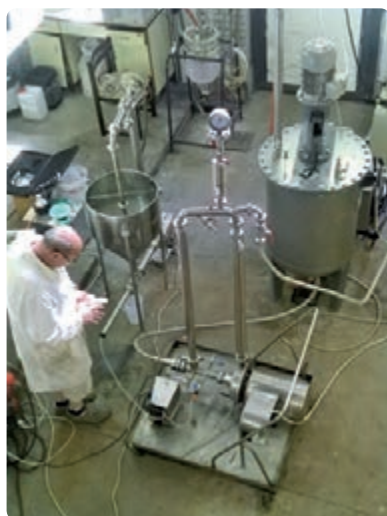
11. ábra: A pilot léptékű technológia eszközei: szerves fázis készítő tartály és hidrodinamikus emulzifikálás, polimerizációs reaktor (baloldali kép), alginát mikrogömböket előállító csepegtető és gélképző reaktor (középen), Niro Mobil Minor® porlasztva szárító (jobbra).
